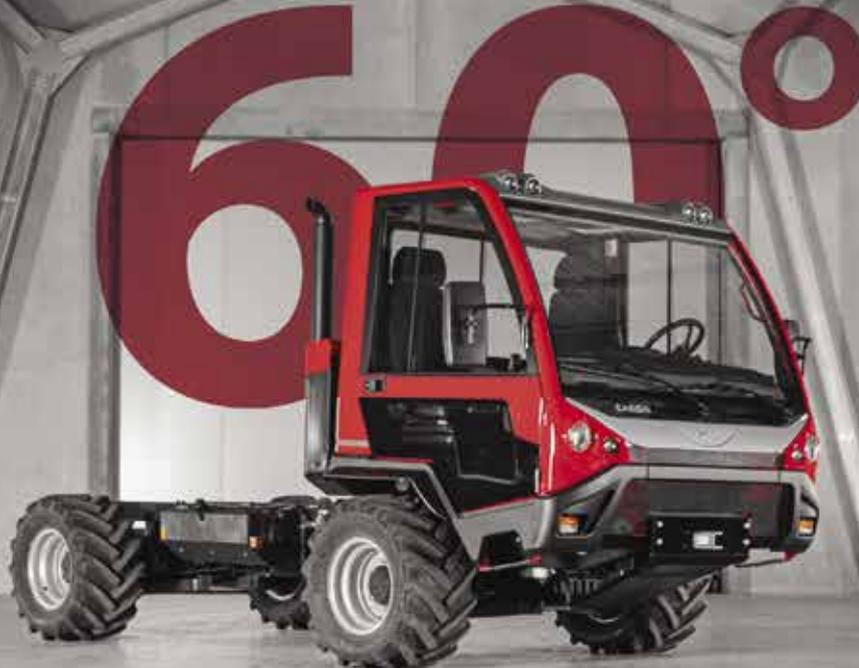
Leistung, Wendigkeit und Komfort: bis 7 Tonnen Nutzlast und 60 km/h Geschwindigkeit. Das Aushängeschild der CARON Transporter, mit der hydropneumatischen Federung oder in der neuen Version mit mechanischer Federung ausgestattet, garantiert beste Eigenschaften im Gelände und ein ausgezeichnetes Fahrverhalten auf der Straße. Auch mit Vierradlenkung und Automatikgetriebe erhältlich ist er Ausdruck einer Innovationsgeschichte, die vor 60 Jahren begonnen hat.
